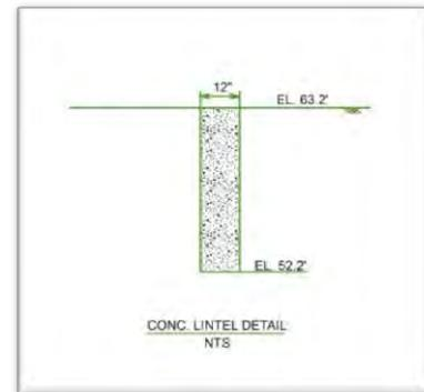
**FIGURE 10 Concrete Lintel**
